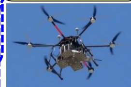
受電部 (受電電力によりLED点灯)
