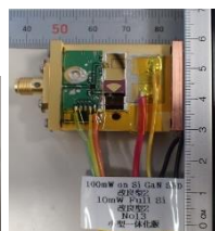
2種類の2回路 HySIC 整流回路
