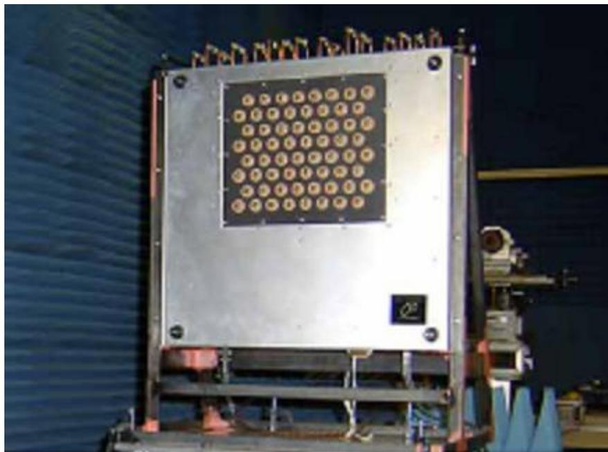
試作した電源アンテナ一体型パネル
