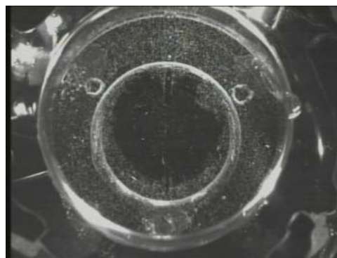
図3 (b)気泡を除去した液柱
